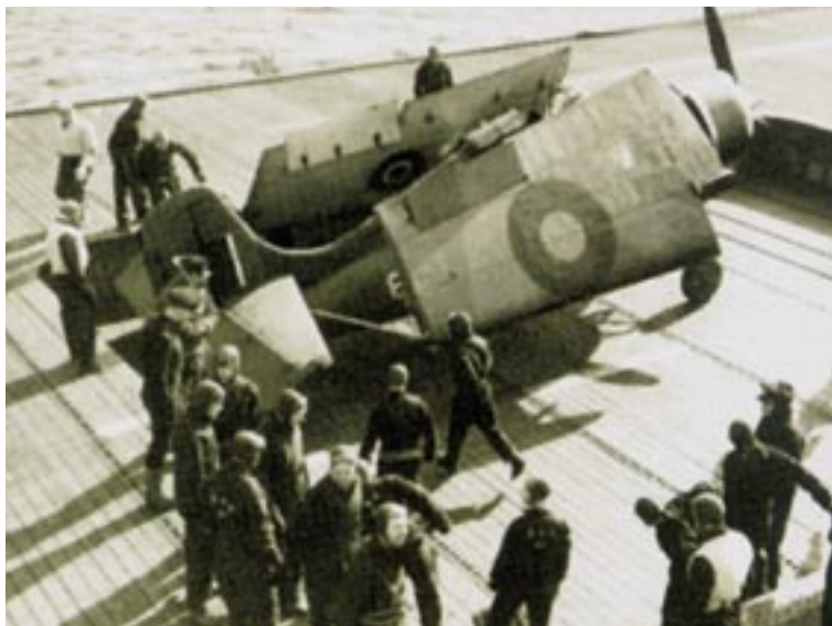
Krídla palubných Wildcatov sa dali skladať pozdĺž trupu kvôli úspore miesta na lietadlových lodiach. Na fotografii je jeden z britských F4F, ktorým prechodne hovorili Martlet. Foto: archiv
