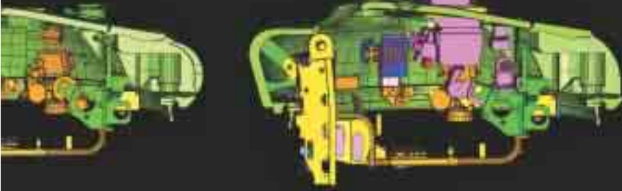
Rez ľavou polovicou veže s porovnaním stavu pred zástavbou nového vybavenia a po zástavbe
