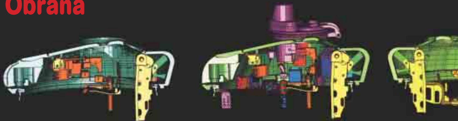
Rez pravou polovicou veže s porovnaním stavu pred zástavbou nového vybavenia a po zástavbe
