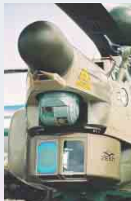
Nos vrtníka - hore je navádzacia anténa systému Ataka-V, pod ňou antény výstražného systému Pastel, malé guľové puzdro termovíznej stanice pilota s laserovým diaľkometerom a valcové puzdro stabilizovanej prehľadovej a zameriavacej stanice operátora
