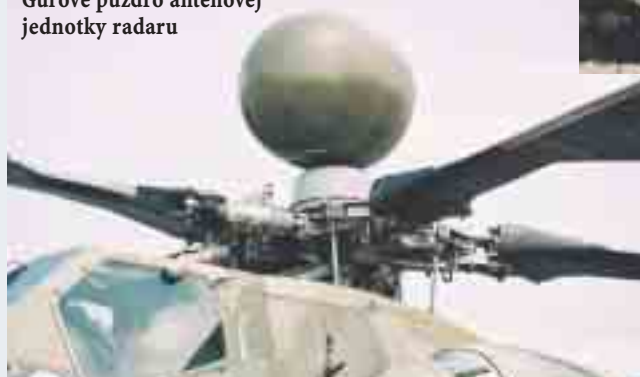
Nos vrtníka - hore je navádzacia anténa systému Ataka-V, pod ňou antény výstražného systému Pastel, malé guľové puzdro termovíznej stanice pilota s laserovým diaľkometerom a valcové puzdro stabilizovanej prehľadovej a zameriavacej stanice operátora
