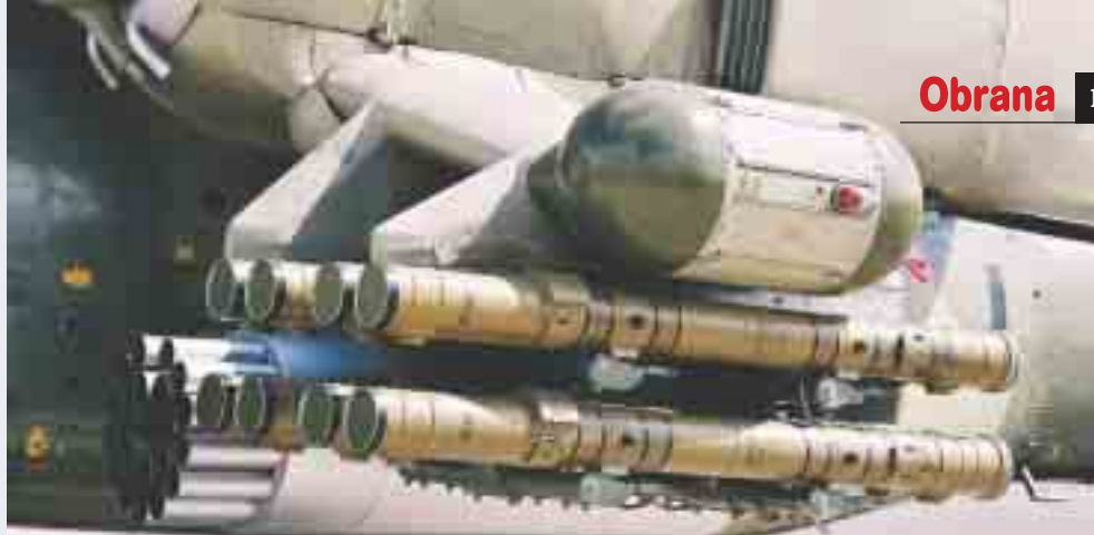
V popredí sú protitankové rakety 9M120 systému Ataka-V. Za nimi vidieť raketový blok B-8V20.
