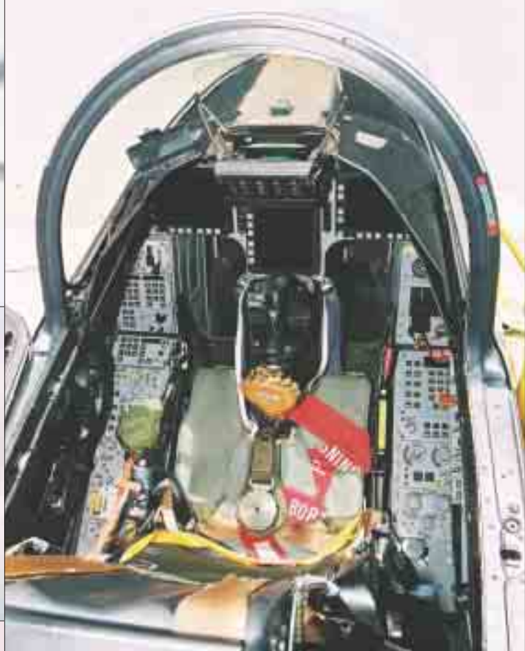
V pilotnej kabíne JAS-39A dominuje trojica viacúčelových displejov a rozmerný priehľadový displej
