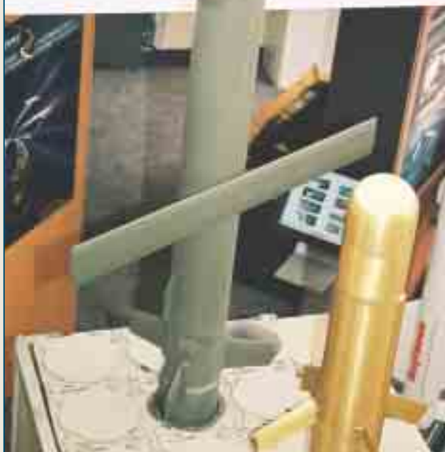
Riadená strela LAM s dobre viditeľným krídlom a rozmiestnením chvostových plôch
