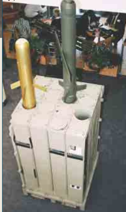
Kontajnerová jednotka CLU s riadenými strelami PAM a LAM. V pravom prednom rohu je blok spojenia a riadenia CCS
