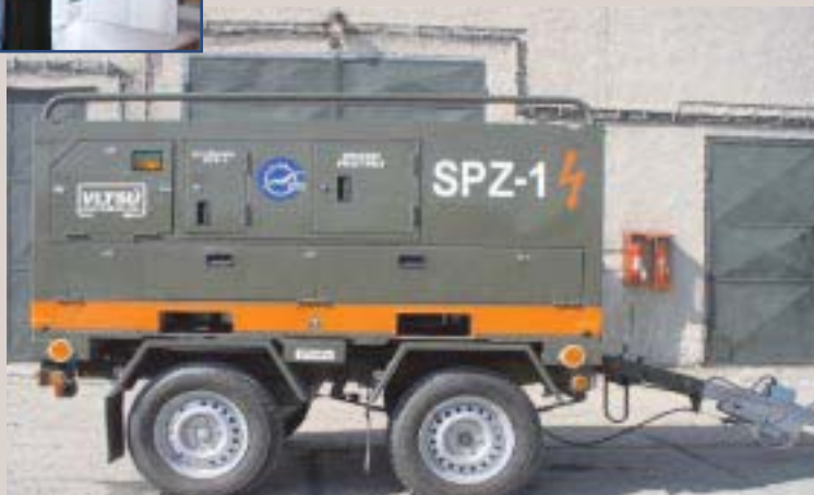
Spúšťacie zariadenie lietadiel (SPZ-1) vzniklo v spolupráci VLTSÚ Košice a Leteckých opravovní Banská Bystrica
