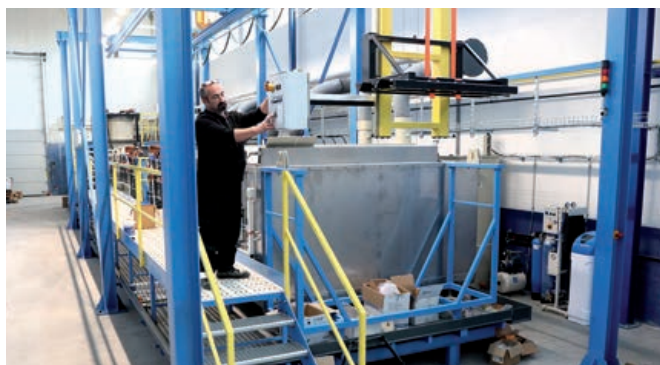
Záverečná montáž novej chrómovacej linky
