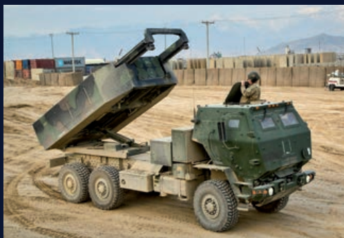
Ľahký salvový raketomet M142 High Mobility Artillery Rocket System (HIMARS)
