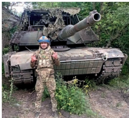
M1A1 Abrams 47. brigády. Ukrajinské Abramsy dostali okrem reaktívnej ochrany aj protidronovú kletku. Vzhľadom na vysoké straty vozidiel z prvej línie stiahli.
