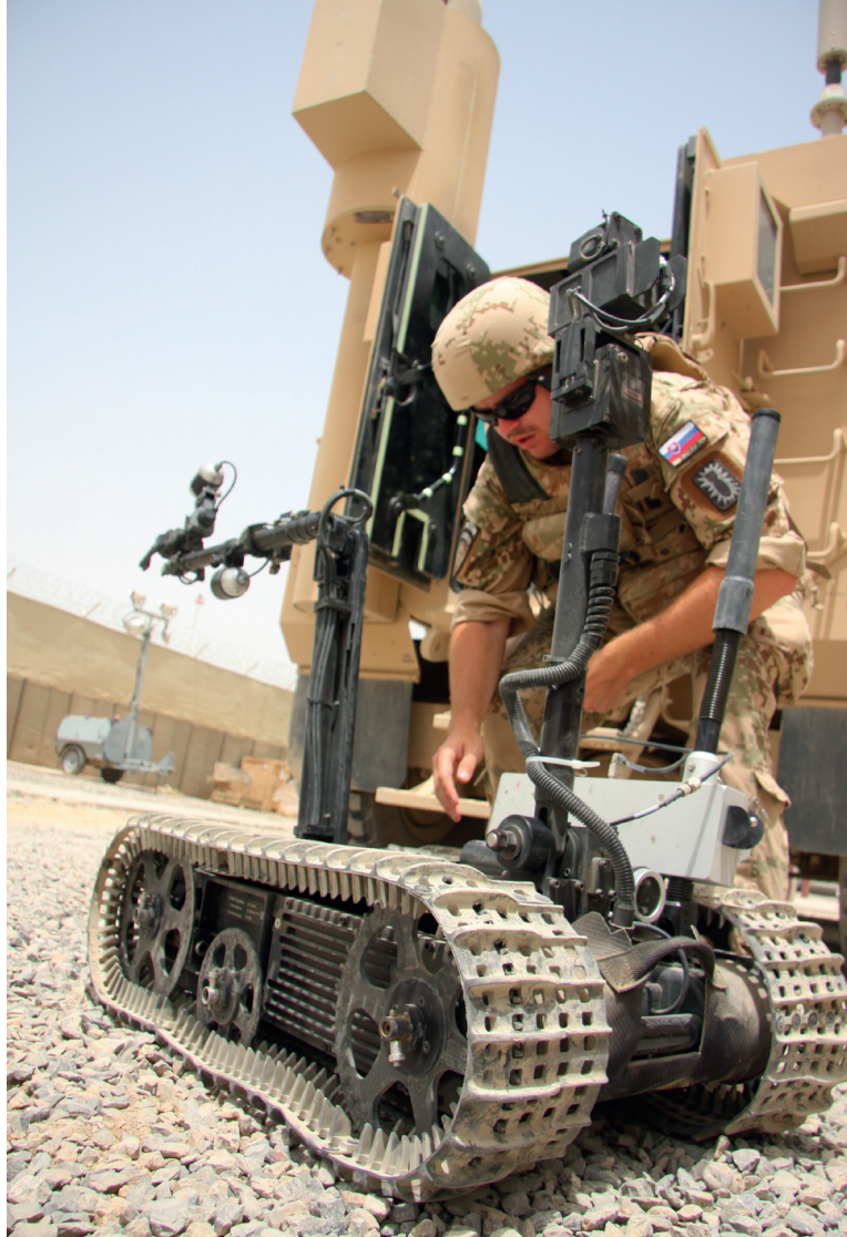
Špecialista EOD s robotom na prieskum a zneškodňovanie nástražných výbušných systémov
