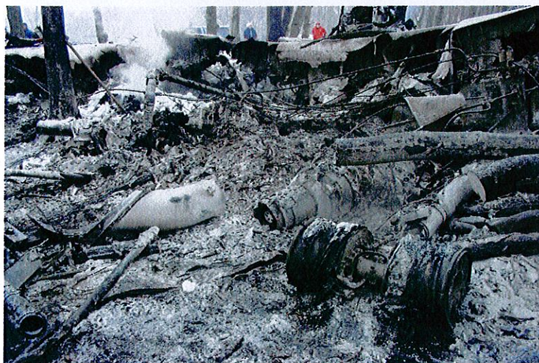
obr. č. 16 Stredná časť trupu s časťou hlavného podvozku
