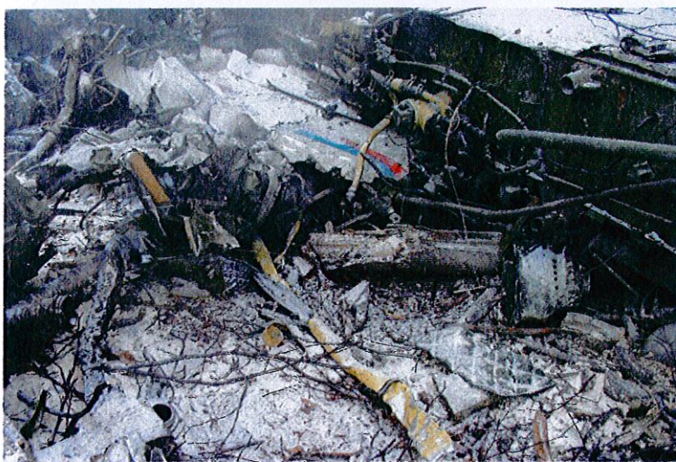
obr. č. 18 Zvyšky centroplánu s palivovým potrubím
