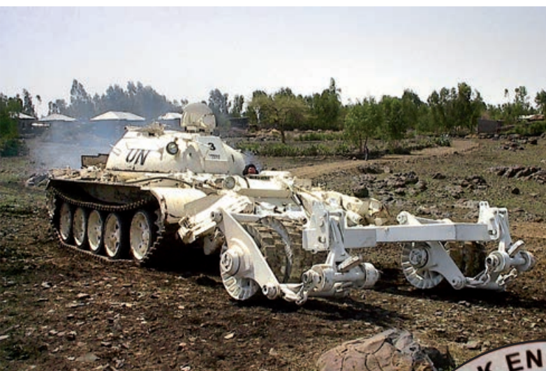
Odmínovací tank Silný jedinec
