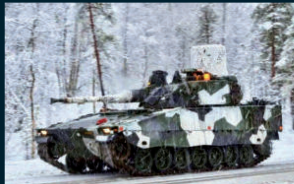
Protiletadlový variant Lkv 90 švédskej armády. Na veži vozidla je inštalovaný radar PS-95.
