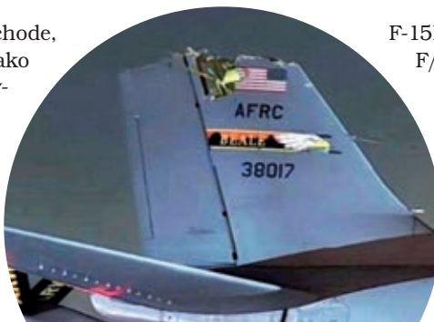
K americkým stratám patrí aj kolízia dvoch tankovacích KC-135. Lietadlo na fotografii dokázalo po kolízii pristáť v Iraku s poškodeným smerovým kormidlom.
