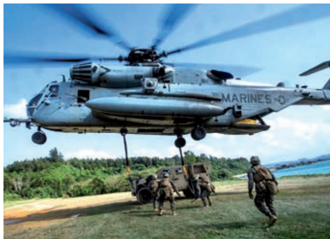
Jednou z požadovaných vlastností JLTV bola možnosť prepravy vrtuľníkom. Na fotografii je v podvese pod ťažkým CH-53E Super Stallion.
