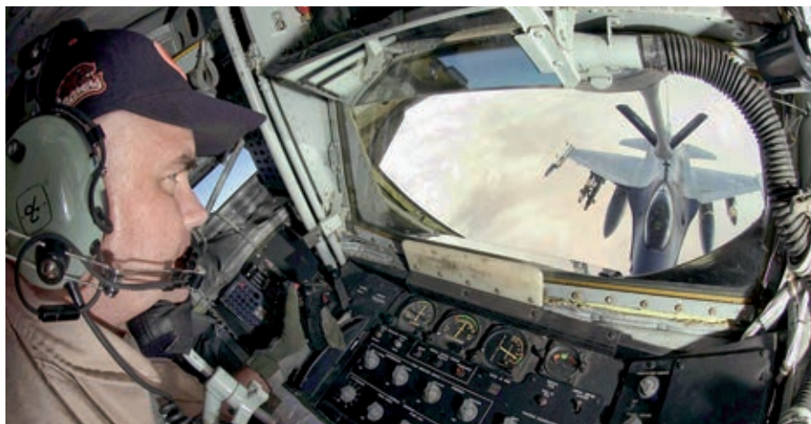
Prietok paliva v tankovacom systéme pomocou rahná kontroluje operátor v zadnej časti trupu s výhľadom na prijímacie lietadlo. Na snímke operátor rahná amerického KC-135 tankuje palivo do F-16.
