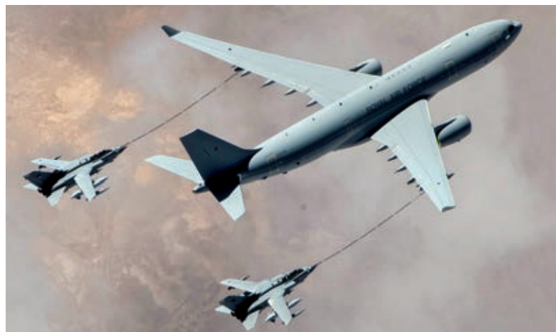
Väčšina moderných tankovacích lietadiel využíva systém hadice aj rahna. Na fotografii britský Airbus A330 MRTT (Voyager KC3) tankuje pomocou hadíc bojové lietadlá Tornado.
