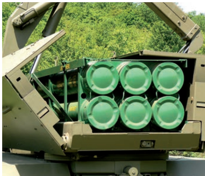
Na rozdiel od starších raketometov môžu Modulary využívať aj rakety aliančného kalibru 227 mm. Na fotografii je kontajner so šiestimi raketami.
